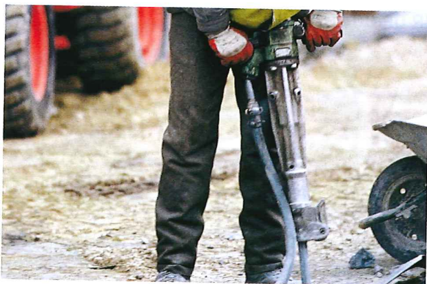
Las máquinas de construcción emplean la energía neumática o hidráulica del aire o el líquido a presión.
