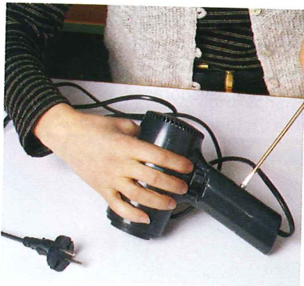
1. Separa las dos partes de la carcasa aflojando los tornillos que las mantienen unidas.
