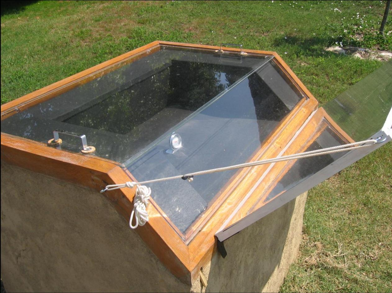
13. Vista del reflector externo, con el que se alcanzan los 120 °C.
