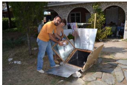
Figura 10: horno 30-60 con alas reflectantes
