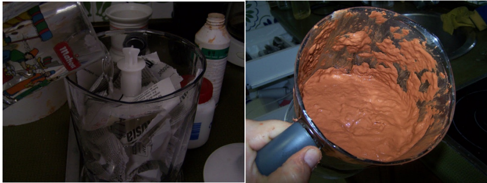
Figura 16: fabricación del adobe de papel
