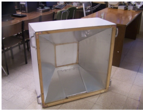
Figura 2: horno reflectante plano (antes de haberle colocado su cristal)
